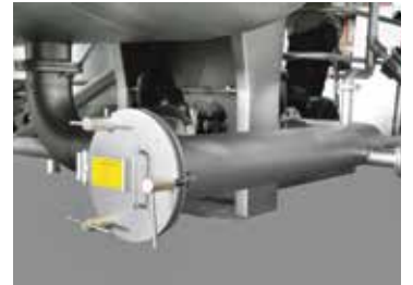
Alt Kollektör Bottom Collector
